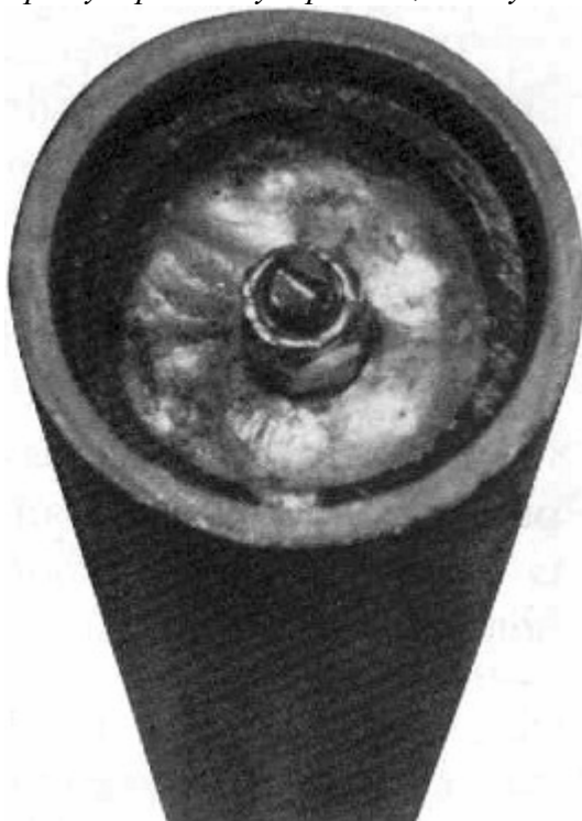
Законченная сборка ударника, установленная в трубе казённого. Обратите внимание на шлиц для отвёртки и крепление сборки медным припоем к трубе.
