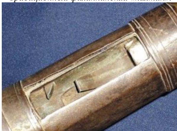
Отражатель и выбрасыватель в окне ствольной коробки «палтика».
