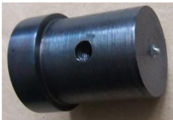
Пробка «затвора» с бойком крупным планом.
